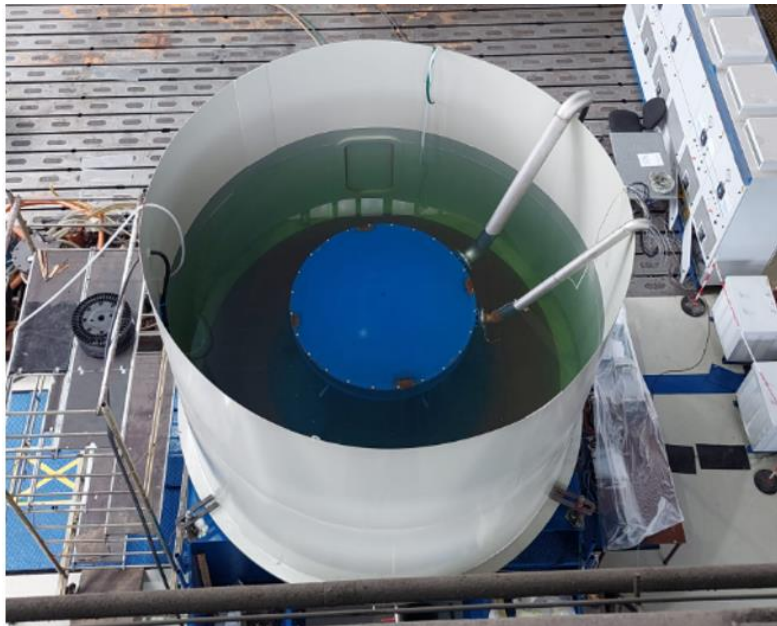
Slika 1: Ispitivanje generatora potopljenog u kadi s vodom i pogonjenog asinkronim motorom koji su spojeni na frekvencijski pretvarač u back to back spoju u ispitnoj stanici
